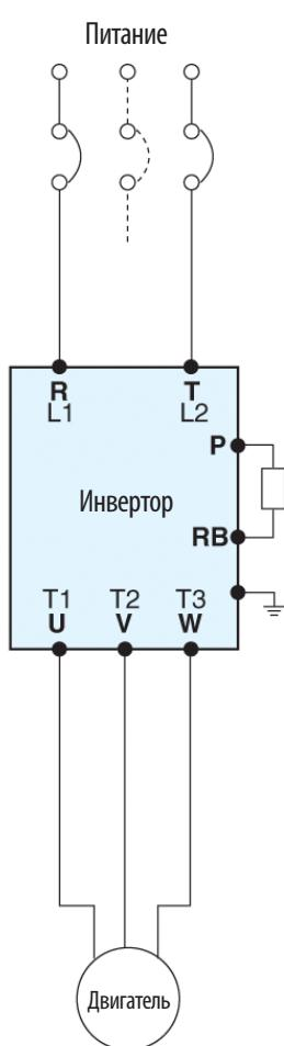
**Компактный размер для легкости установки**
