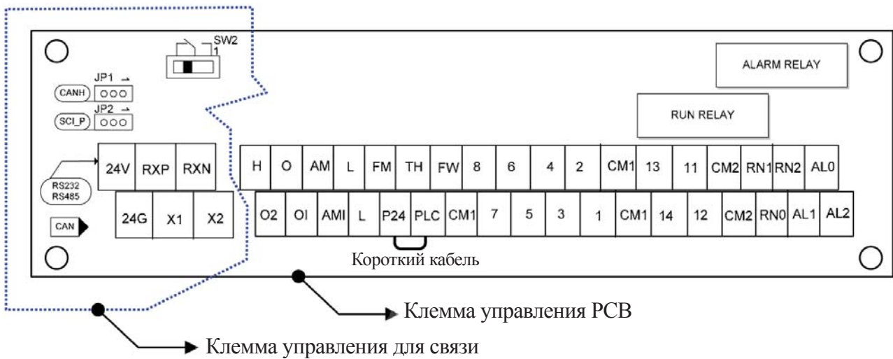
Рис. 13-2 Спецификация порта RS485 (Клемма управления РСВ)
