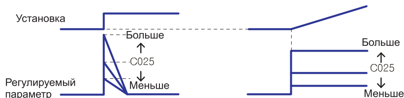
Рис. 11-9 Компоненты ПИД (D действие)
