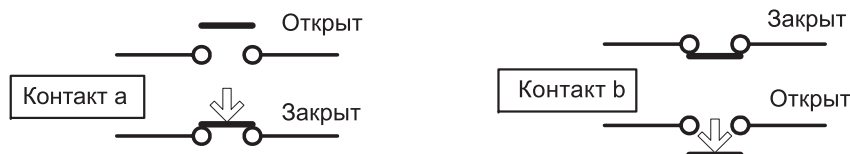
Рис. 9-7 Схема функционирования контакта а и контакта в
