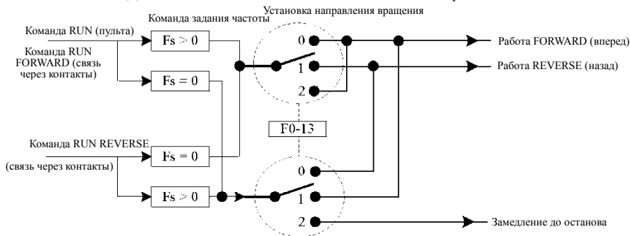
Рис. 4-22. Иллюстрация выбора направления вращения двигателя
