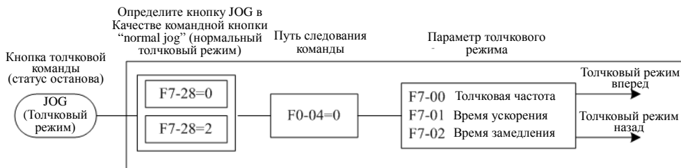
Рис. 4-15. Иллюстрация настройки параметра толчкового режима
