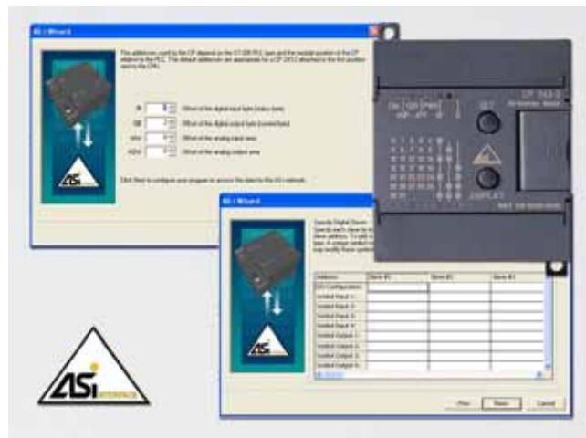
Коммуникационный процессор CP 243-2 устанавливается в программируемые контроллеры S7-200 с центральными процессорами CPU 22x (исключая CPU 221) и поддерживает расширенный набор функций ведущего устройства AS-Interface V2.1:
