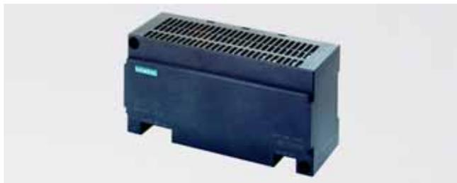
Блоки питания SITOP Power 24 В/3.5 А предназначены для питания центральных процессоров и модулей программируемых контроллеров S7-200, а также их внешних цепей. Они выполняют преобразование входного однофазного напряжения переменного тока промышленной частоты в стабилизированное выходное напряжение  $\approx 24$  В и обеспечивают электронную защиту от коротких замыканий в цепи нагрузки.
