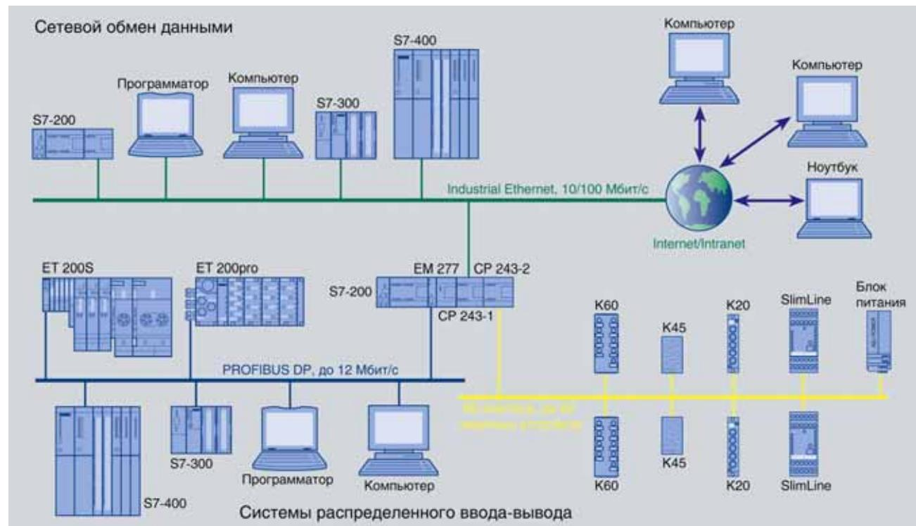
Все центральные процессоры S7-200 за исключением CPU 221 оснащены шиной расширения, позволяющей производить подключение необходимого набора модулей расширения. Через эту шину к центральному процессору могут подключаться как обычные модули ввода-вывода, так и коммуникационные модули.
