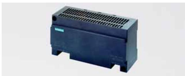
Блоки питания SITOP Power 24 В/3.5 А предназначены для питания центральных процессоров и модулей программируемых контроллеров S7-200, а также их внешних цепей. Они выполняют преобразование входного однофазного напряжения переменного тока промышленной частоты в стабилизированное выходное напряжение =24 В и обеспечивают электронную защиту от коротких замыканий в цепи нагрузки.
