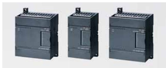
Модули ввода-вывода аналоговых сигналов предназначены для подключения к контроллеру аналоговых датчиков и исполнительных устройств. Модули ввода аналоговых сигналов выполняют аналого-цифровое преобразование входных аналоговых сигналов контроллера и формируют цифровое представление измеренных величин. Модули вывода выполняют цифро-аналоговое преобразование внутренних цифровых величин контроллера и формирование его выходных аналоговых сигналов. В системе ввода-вывода S7-200 могут применяться:
