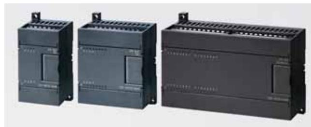
Модули ввода-вывода дискретных сигналов предназначены для увеличения количества входов и выходов, обслуживающихся одним центральным процессором. Для этой цели могут быть использованы:
