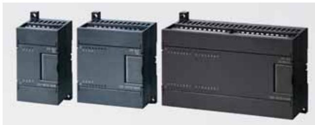
Модули ввода-вывода дискретных сигналов предназначены для увеличения количества входов и выходов, обслуживаемых одним центральным процессором. Для этой цели могут быть использованы:
