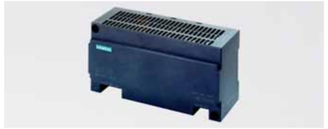
со степенью защиты IP 20. Он оснащен одной парой клемм для подключения к аккумуляторной батарее и одной парой клемм для подключения нагрузки. Модули крепятся на 35 мм профильные шины DIN в вертикальном или горизонтальном положении.
