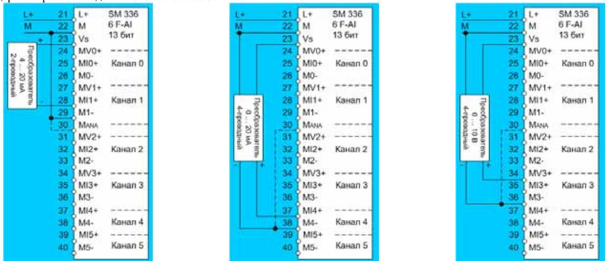
Стандартный режим ввода аналоговых сигналов в резервированных системах автоматизации
