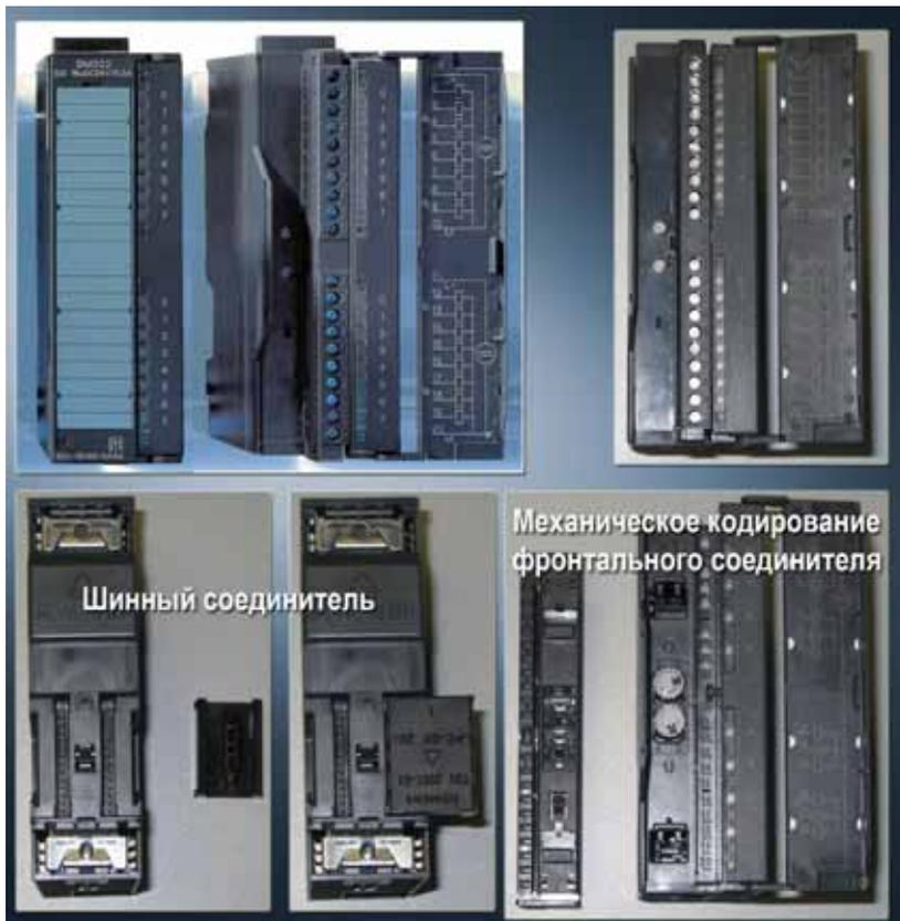
Фронтальный соединитель не входит в комплект поставки модуля и должен заказываться отдельно. Возможен заказ фронтальных соединителей, обеспечивающих подключение внешних цепей через контакты с винтовыми зажимами или через пружинные контакты-защелки.
