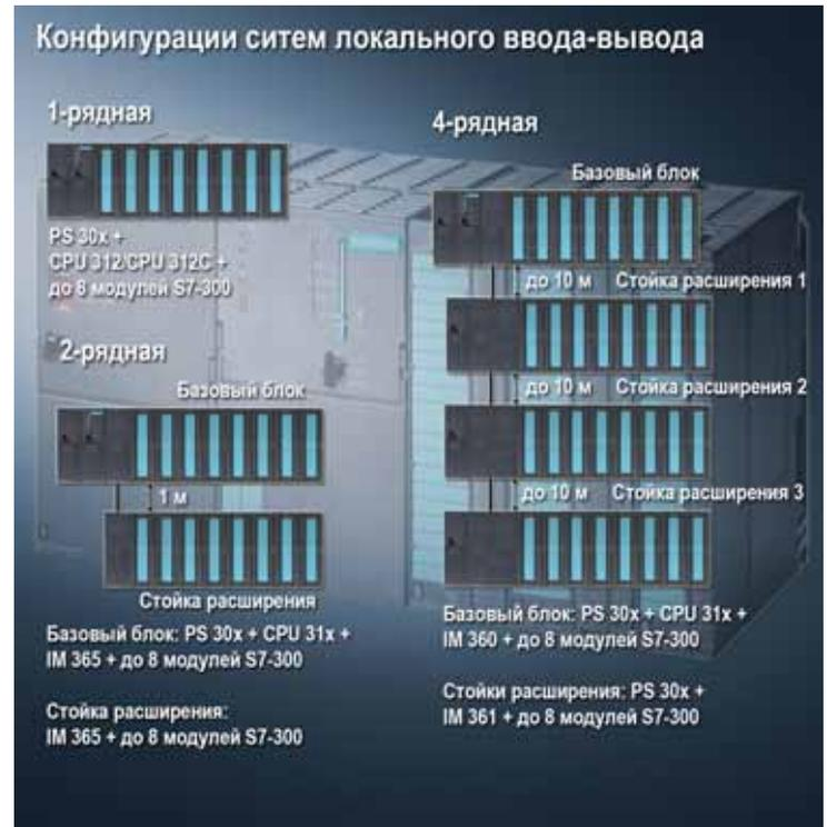
Система локального ввода-вывода программируемого контроллера S7-300 с CPU 312/ CPU 313 может включать в свой состав не более 8 сигнальных, функциональных и коммуникационных модулей. Все модули в этом случае размещаются на одной монтажной стойке.
