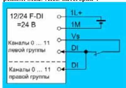
Подключение датчика с проверкой одинаковых состояний цепей двух входов
