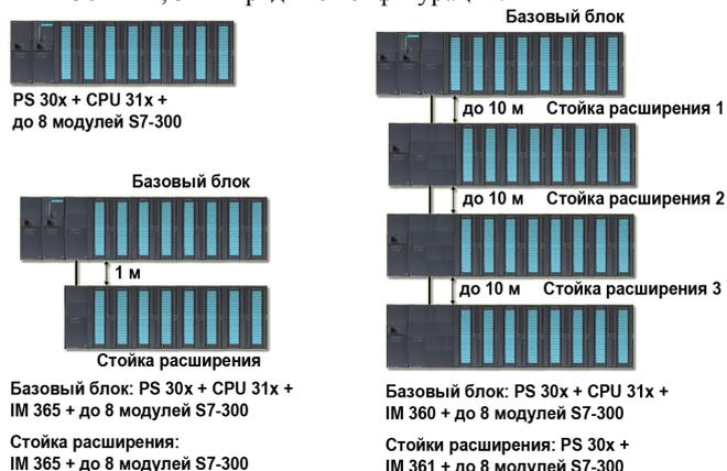
Конструкция контроллера отличается высокой гибкостью и удобством обслуживания:
