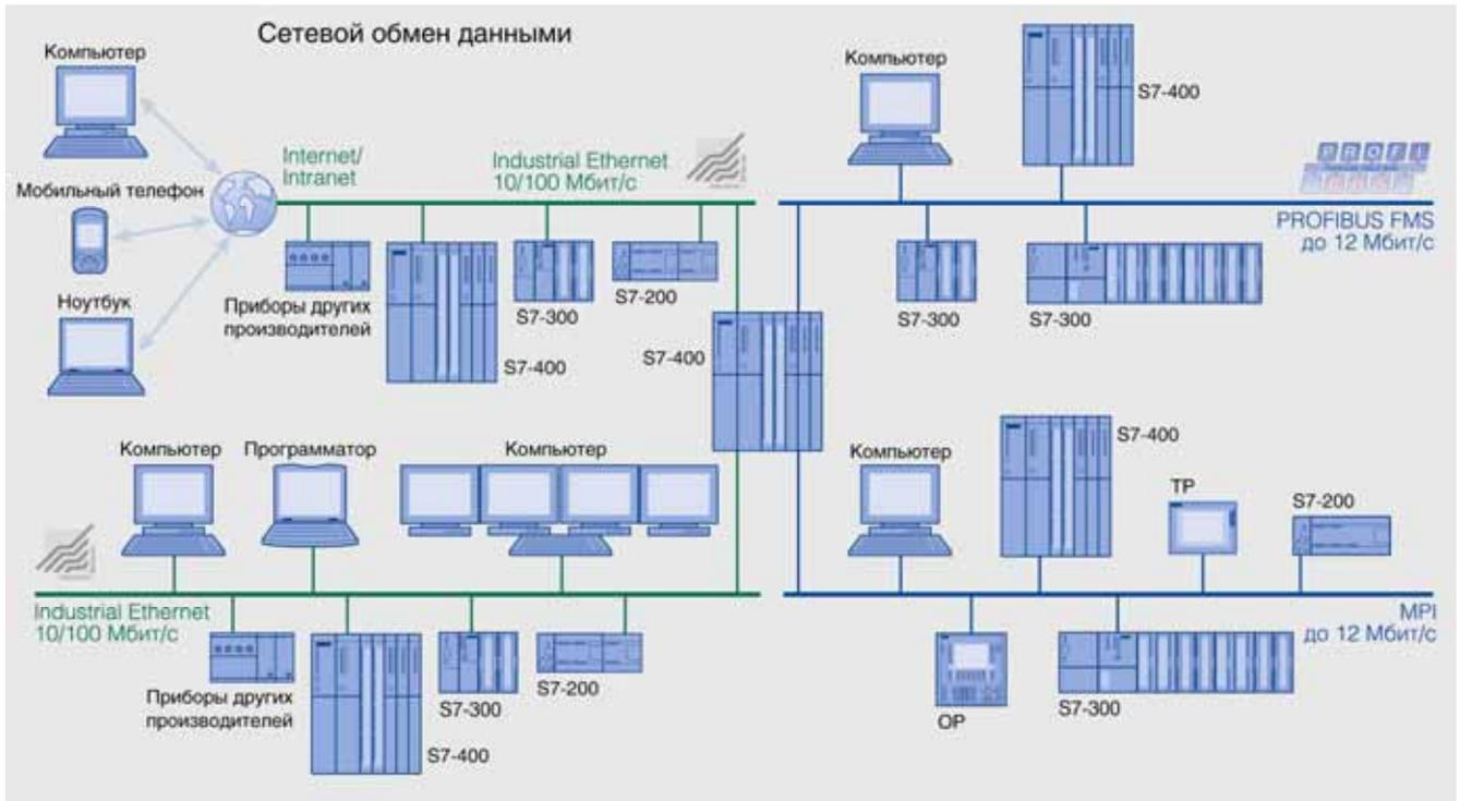
Для организации обмена данными между S7-400 и интеллектуальными сетевыми устройствами преимущественно используются сети MPI, PROFIBUS и Industrial Ethernet. Обмен данными может происходить различными способами:
