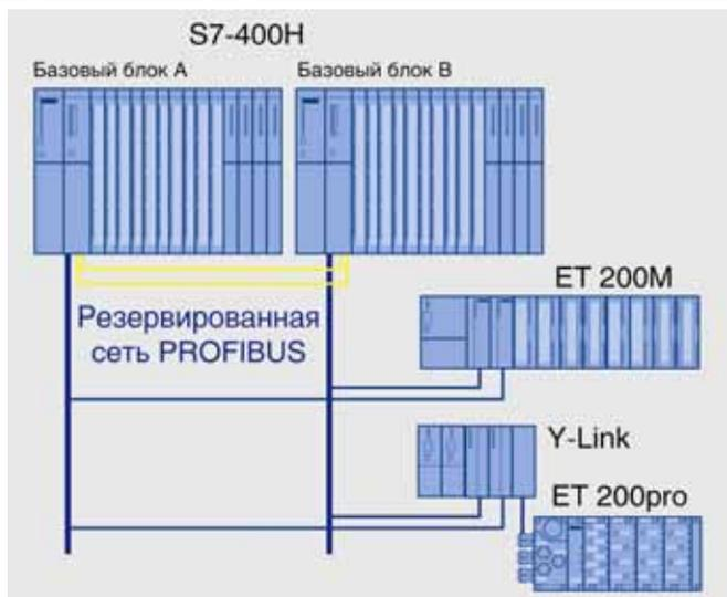
В переключаемой конфигурации доступ ко всем каналам ввода-вывода имеют оба центральных процессора S7-400H. Резервированные пары модулей ввода-вывода могут устанавливаться:
