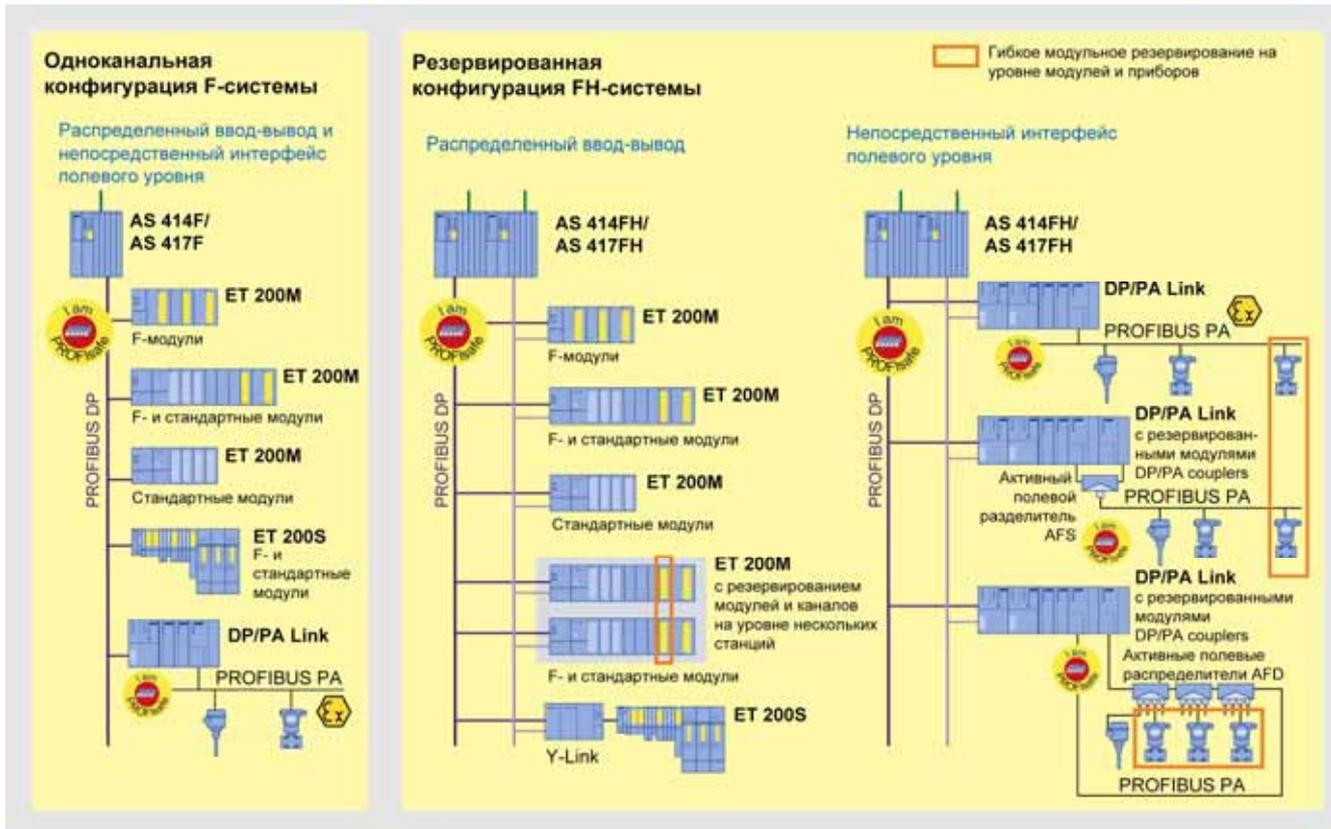
В номенклатуре сигнальных модулей программируемых контроллеров S7-400 отсутствуют F-модули, поэтому для построения систем противоаварийной защиты и автоматики безопасности на базе контроллеров S7-400F/FH используются только системы распределенного ввода-вывода на основе сетей PROFIBUS DP и PROFINET IO.
