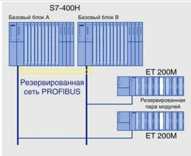
Симметричной установкой двух одинаковых модулей в две станции ET 200M одноканальной системы распределенного ввода-вывода программируемого контроллера S7-400H
