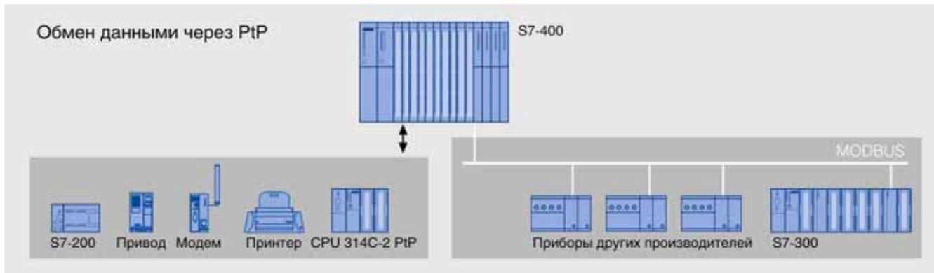
Связь через PtP (Point-to-Point Interface) интерфейсу осуществляется с помощью коммуникационных процессоров CP 440 и CP 441, в которых могут использоваться последовательные интерфейсы TTY (20 мА токовая петля); RS 232C/V.24 или RS 422/RS 485. Поддерживаемые протоколы и скорость обмена данными определяются типом коммуникационного процессора, типом используемого последовательного интерфейса и используемым программным обеспечением. В комплект
