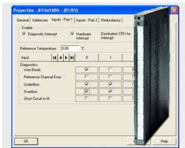
Разрешающая способность модулей может быть установлена в пределах 13...16 бит плюс знаковый разряд. От этого параметра зависит и время аналого-цифрового преобразования.
