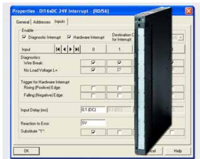
Модули ввода дискретных сигналов предназначены для преобразования входных дискретных сигналов контроллера в его внутренние логические сигналы. К входам модулей могут подключаться контактные датчики, а также бесконтактные датчики BERO.
