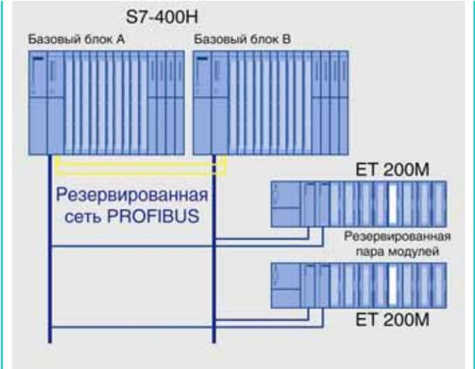
Симметричной установкой двух одинаковых модулей в две станции ET 200M переключаемой конфигурации системы распределенного ввода-вывода программируемого контроллера S7-400H
