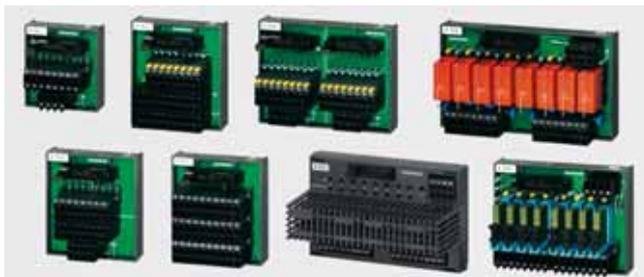
Терминальные блоки оснащены разъемом для подключения ленточного соединительного кабеля SIMATIC TOP Connect, а также набором клемм для подключения внешних цепей контроллера (цепей датчиков и исполнительных устройств). Каждый терминальный блок позволяет производить подключение до 8 сигнальных цепей. В зависимости от модификации терминальные блоки могут иметь контакты с винтовыми зажимами или пружинные контакты-заселки. Все терминальные блоки монтируются на стандартную 35 мм профильную шину DIN.
