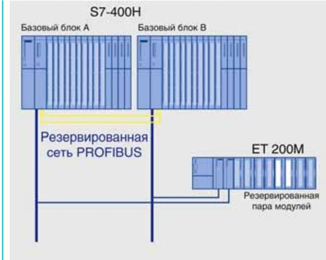
Симметричной установкой двух одинаковых модулей в одну станцию ET 200M переключаемой конфигурации системы распределенного ввода-вывода программируемого контроллера S7-400H
