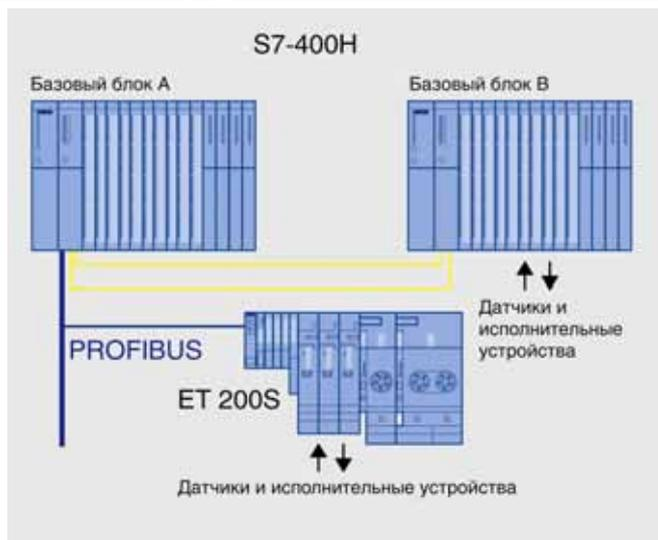
В одноканальной конфигурации обращение к модулям ввода-вывода способен выполнять только один из двух центральных процессоров контроллера. Модули ввода-вывода могут устанавливаться:
