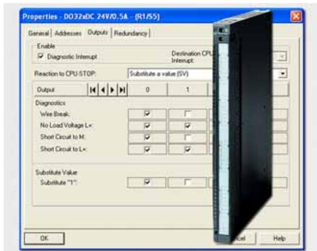
Модули вывода дискретных сигналов предназначены для преобразования внутренних логических сигналов контроллера в его выходные дискретные сигналы. К выходам модулей могут подключаться соленоидные вентили, реле, контакторы, сигнальные лампы, небольшие двигатели и т.д.
