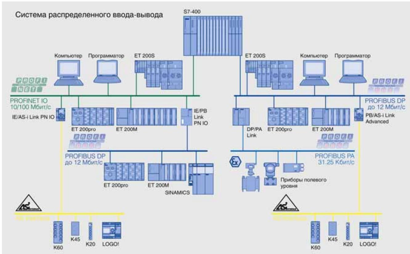
Системы распределенного ввода-вывода программируемых контроллеров S7-400 могут строиться на основе промышленных сетей PROFIBUS DP, PROFINET IO и/или AS-Interface. Преимущественно в таких сетях используется скоростной циклический обмен данными между ведущим и ведомыми сетевыми устройствами. Асинхронный обмен данными находит применение для выполнения диагностических функций.
