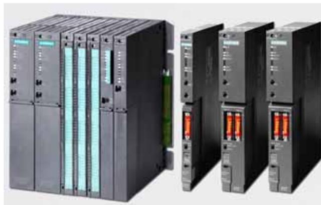
замены одного из резервированных блоков питания без потери работоспособности контроллера.
