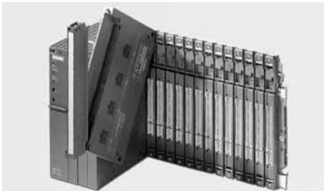
S7-400 является универсальным контроллером. Он отвечает жестким требованиям промышленных стандартов, обладает высокой степенью электромагнитной совместимости, высокой стойкостью к ударным и вибрационным нагрузкам. Установка и замена модулей контроллера, а также модулей подключенных к нему станций систем распределенного ввода-вывода может производиться без отключения питания (“горячая замена”).
