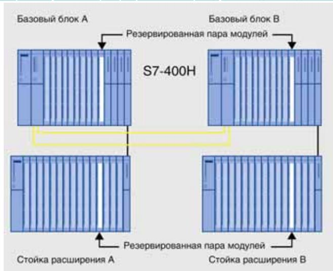
Симметричной установкой двух одинаковых модулей в базовые блоки или стойки расширения программируемого контроллера S7-400H
