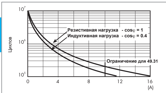
F 49 - Электрическая долговечность (AC) при ном. нагрузке, Типы 49.31/61/81
