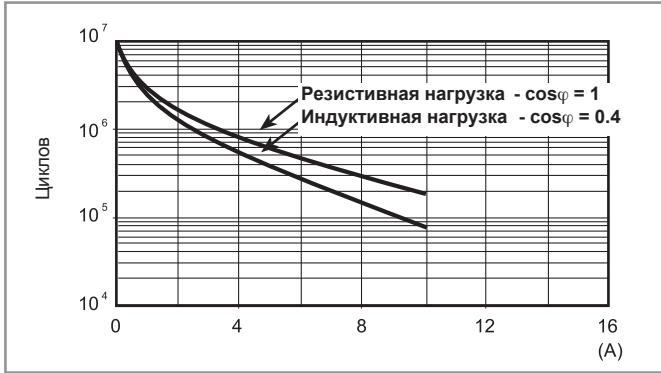
F 40 - Электрическая долговечность (AC) при ном. нагрузке Типы 40.11
