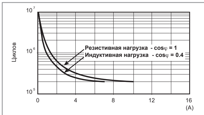
F 60 - Электрическая долговечность (AC) при ном. нагрузке
