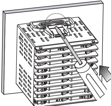
※ Вставьте контроллер в панель, закрепите скобы, прижимая их с помощью инструмента, как показано выше (в случае установки контроллера серии TC4Y закрепите скобы с помощью болтов).
