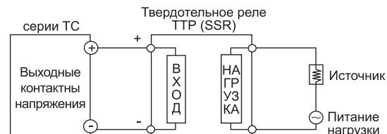
※ Твердотельное реле выбирается исходя из мощности нагрузки, иначе может возникнуть короткое замыкание и возгорание. Для эффективной работы вместе с твердотельным реле должен применяться непрямой нагрев.
