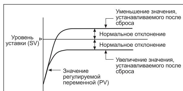
\* Функция ручного сброса применима только в режиме управления П- и ПД-регулятора.
